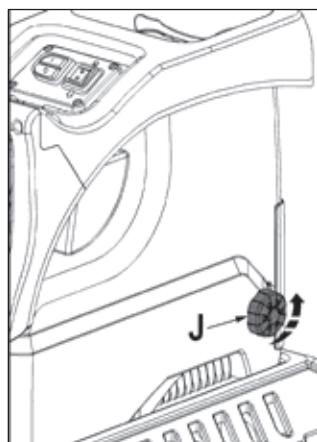
стрелка (така се увеличава разстоянието между насрещния нож и режещия валяк). След това натиснете превключвателя за обръщане на посоката на въртене на **↑ ОБРАТЕН ХОД**, за да продължите работата. Заседналият материал се освобождава.
